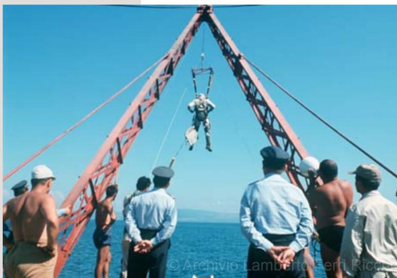
*In una prima fase il pilota, con addosso tuta anti G, casco, scarponcini e imbracatura da paracadute, era sollevato dalla gru del pontone ad una decina di metri d'altezza. Poi veniva fatto scendere velocemente verso l'acqua. Prima dell'impatto il pilota doveva azionare gli sganci rapidi dell'imbracatura a evitare, una volta in acqua, di impigliarsi nei cavi e nella calotta del paracadute.*
