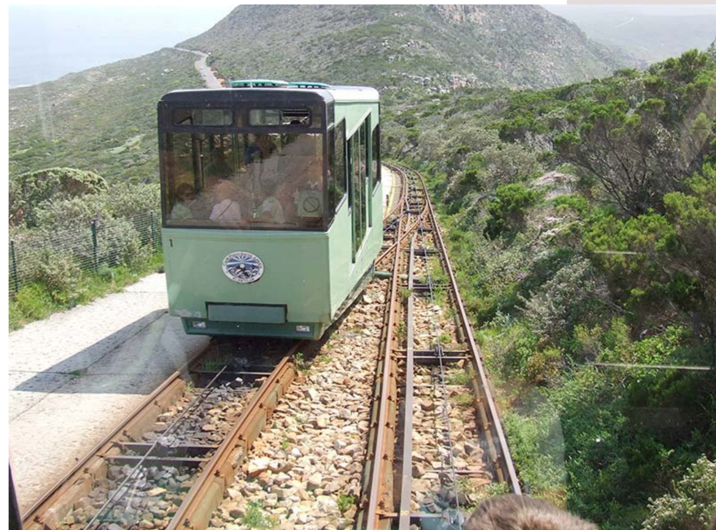
La funicolare è una modalità di trasporto che ha come caratteristica l'utilizzo di una fune come organo di trazione e il movimento su classici binari. Le funicolari hanno in genere due vetture collegate da un cavo e si muovono simultaneamente su un binario unico, una in salita e una in discesa, con un incrocio a metà percorso. Foto David Graham.
