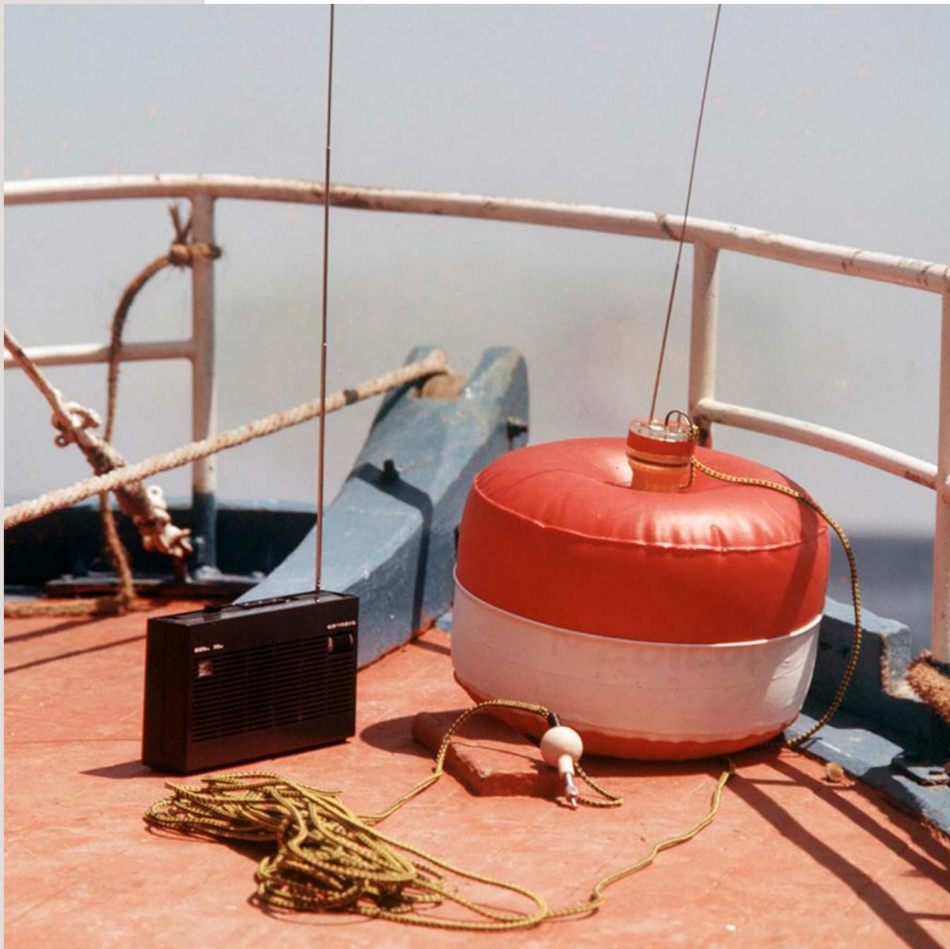
*Il sub in immersione parla con i colleghi in superficie utilizzando un idrofono subacqueo. Il segnale è inviato a una micro trasmittente posizionata nella parabola di una torcia subacquea inserita in un pallone segnasub. La ricevente, da tenere a terra o sulla barca, è una comunissima radiolina portatile a modulazione di frequenza.*
