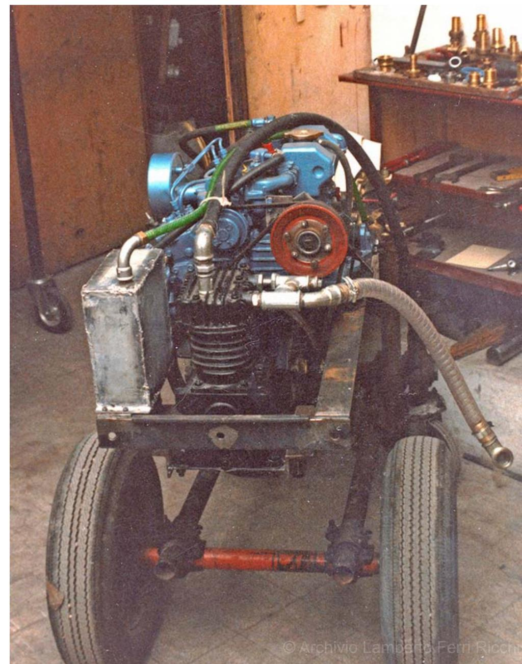
Per il mio "minisub" decisi di utilizzare un motore diesel da dieci hpi: in superficie potevo spostare il mezzo subacqueo a velocità sostenuta mentre in immersione sarebbe stata sufficiente la potenza erogata dal motore quando girava quasi al minimo, quindi con consumi d'aria contenuti. Il motore era protetto da un cilindro d'acciaio. Le tubazioni collegate al cilindro servivano a raffreddare i gas di scarico che, successivamente, erano espulsi da un'apposita pompa.
